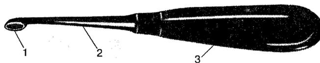
Рис. 34. Элементы конструкции острой костной ложки
